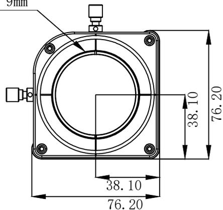
M4  $\times$  0.25 细牙螺纹幅带锁紧
