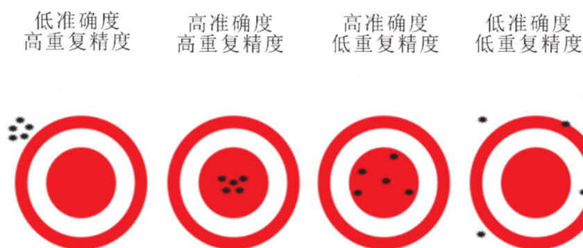
图1. 准确度与重复精度的区别
