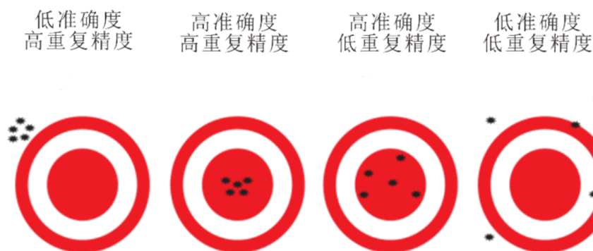
图1. 准确度与重复精度的区别
